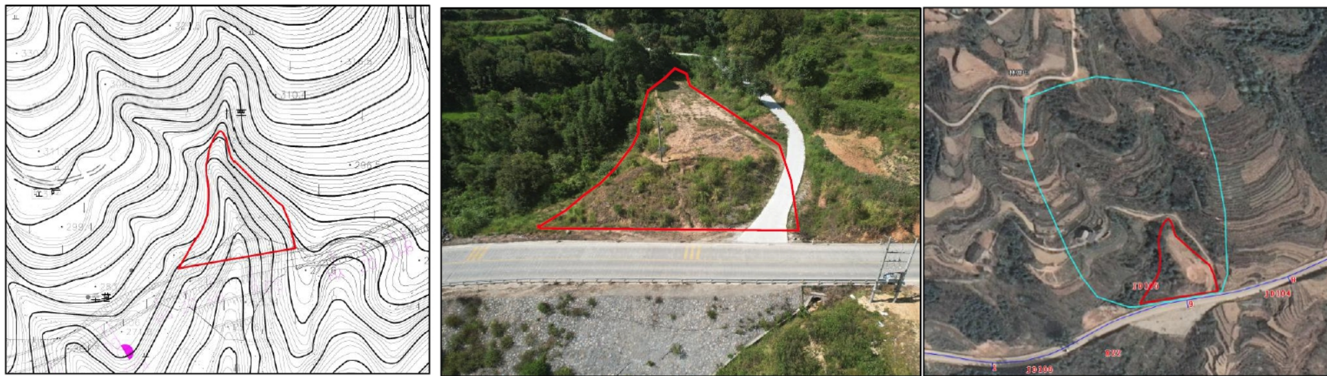
图 3.2.1-19 19#弃渣场 (K21+900 右) 地形图、现状照片及卫星影像图
