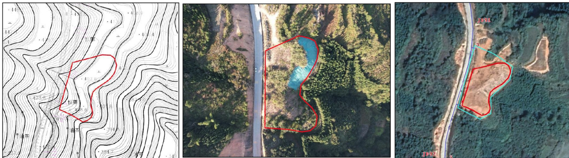
图 3.2.1.12 12#弃渣场 (K19+400 左) 地形图、现状照片及卫星影像图
