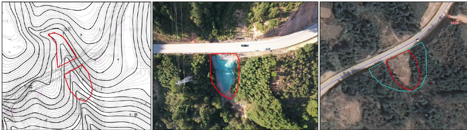
图3.2.1-15 15#弃渣场 (K20+600 左) 地形图、现状照片及卫星影像图
