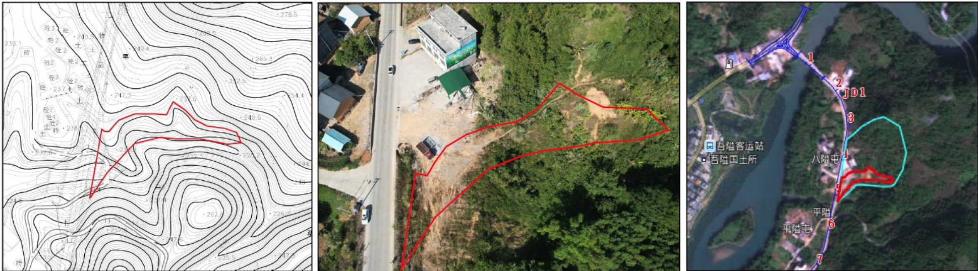
图 3.2.1.1 1#弃渣场（K0+500 左）地形图、现状照片及卫星影像图（影像图中红色为弃渣范围、青色为汇水范围，下同）
