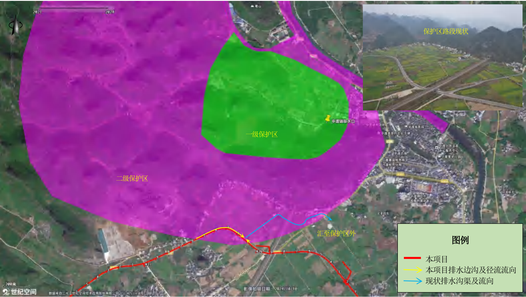
图 4.3-13 中渡镇饮用水源保护区所在路段排水现状示意图
