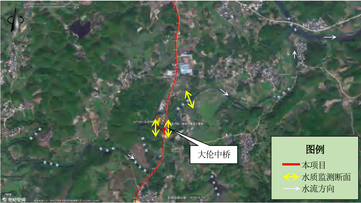
图 4.2-5 (2) 施工期福龙河水水质监测断面位置示意
