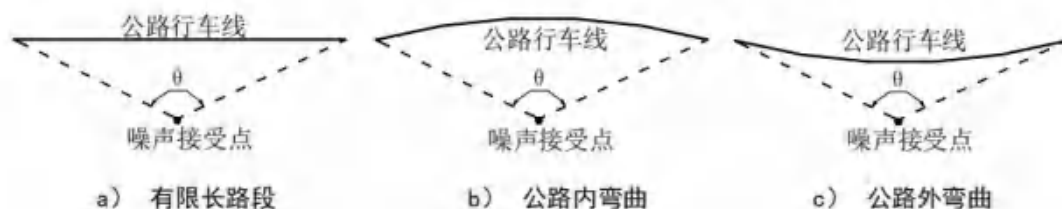
图4.3-1 预测点到有限长路段两端的张角
