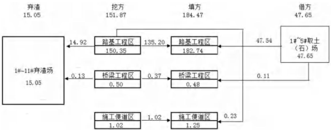
图 2.5-6 项目土石方流向框图 单位：万 m 3
