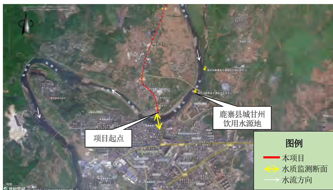
图 4.2-5 (1) 施工期洛清江水质监测断面位置示意
