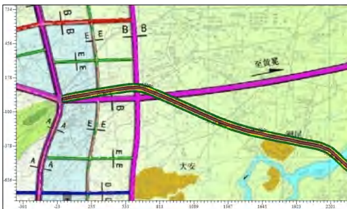
图 4.3-12 穿越沙埔镇规划区路段远期夜间平面等声级线图
